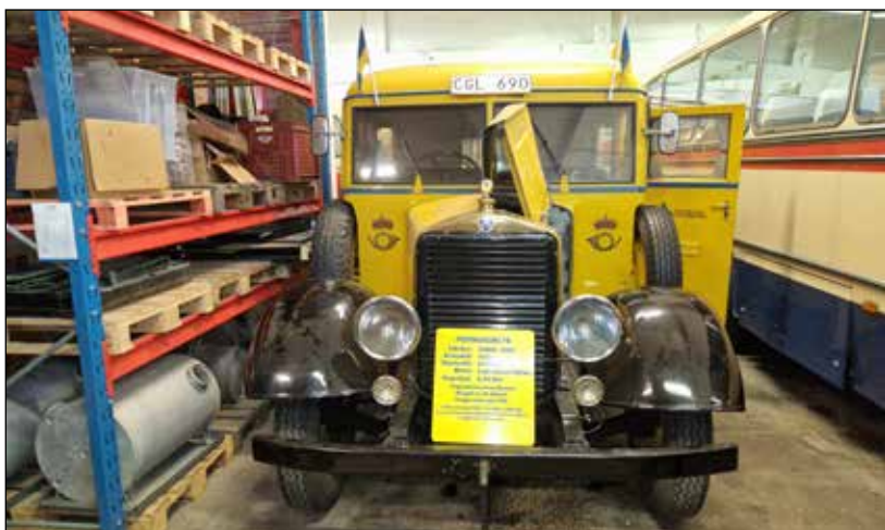
Renault TN4H, 1932. Bussen har sitt ursprung på hästdragen vagn. Förarsätet är den forna kuskbocken. 1936 monterades rutor och dörrar, från början var den helt öppen fram. Motorn är en 6 cylindrig bensinmotor på 58 hk, toppfart ca 40 km/t. 41 sittande passagerare+förare, mekaniker och konduktör
